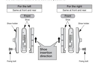
4. Tighten the fixing bolt.
